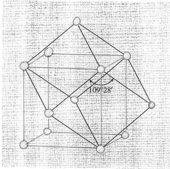
**Bild 1.11:** Primitive Einheitszelle des kubisch raumzentrierten Gitters. Die primitive Zelle ist ein Rhomboeder mit der Seitenlänge  $\frac{1}{2}\sqrt{3}a$ ; der Winkel zwischen sich schneidenden Kanten beträgt  $109^{\circ}28'$ .
